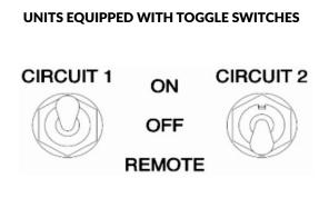
NOTE: CIRCUIT 1 IS IN THE ON POSITION AND CIRCUIT 2 IS IN THE REMOTE POSITION
